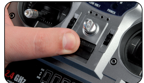
Step 6: Switch on the radio De zender aanzetten Allumez l' émetteur Sender einschalten
