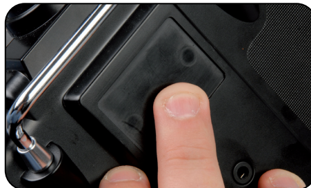
Step 5: Push the LINK button and hold Druk op de LINK knop en houd de knop ingedrukt Poussez sur le bouton LINK et tenez le Das LINK knopf eindrücken und festhalten
